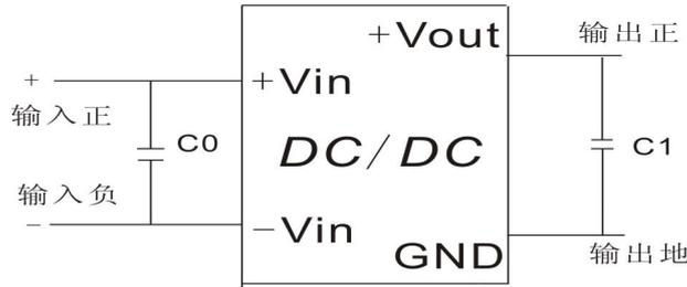
**2、输入反射纹波电流测试电路:**
